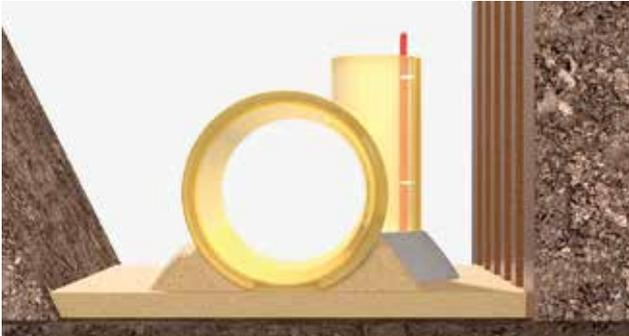
Abb. 3.5 | Betonverfüllung unterhalb des Auftrittes
